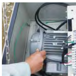
停電時のブレーキ解放レバー
